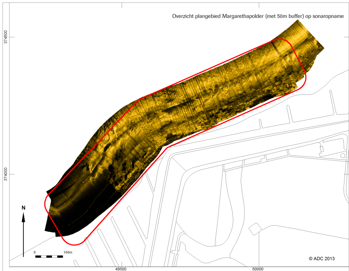
Afb. 50. Side scan sonarmozaïek van de Margarethapolder.
