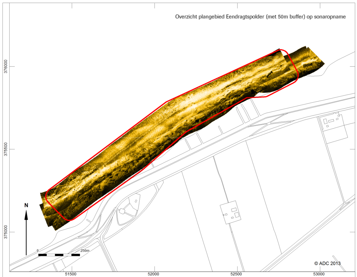
Afb. 55. Side scan sonarmozaiek van de Eendragtspolder.
